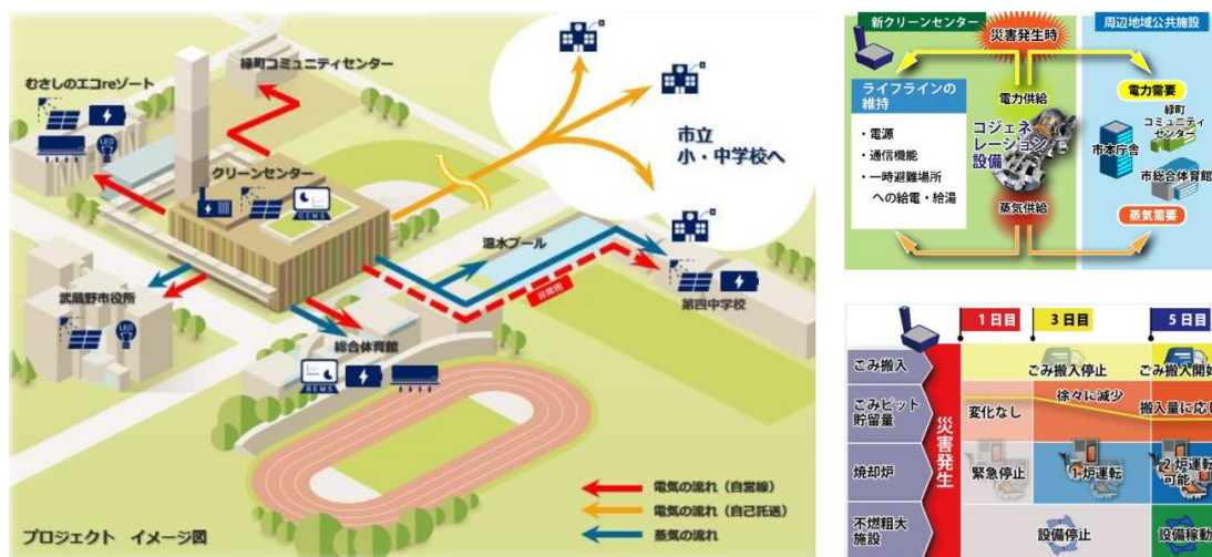
図 4-4-1 ガスコージェネレーション導入事例（武蔵野市）
