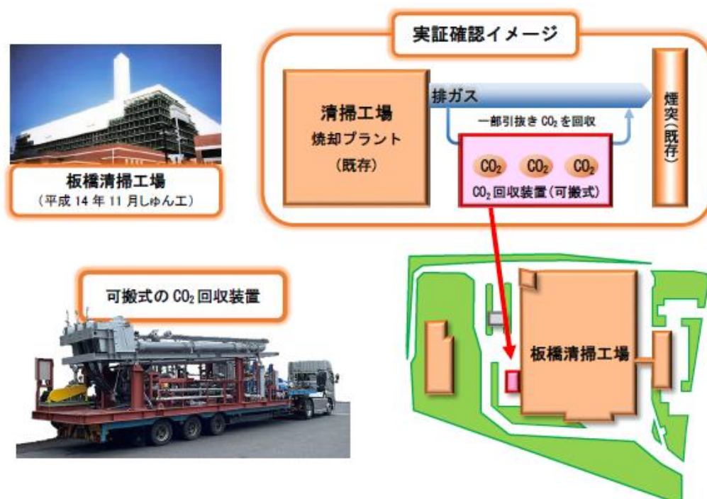
図 4-4-4 CO 2 分離回収の実証試験事例（東京二十三区清掃一部事務組合）
