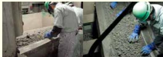
磁選機で取り除けなかった非鉄金属（アルミなど）を作業員が手で選別し取り除きます。
