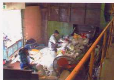
手作業による不適物除去
